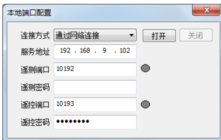
图 6.8.4 b) 本机端口配置，网络（TCP）模式
