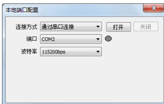
图 6.8.4 a) 本机端口配置，串口模式
