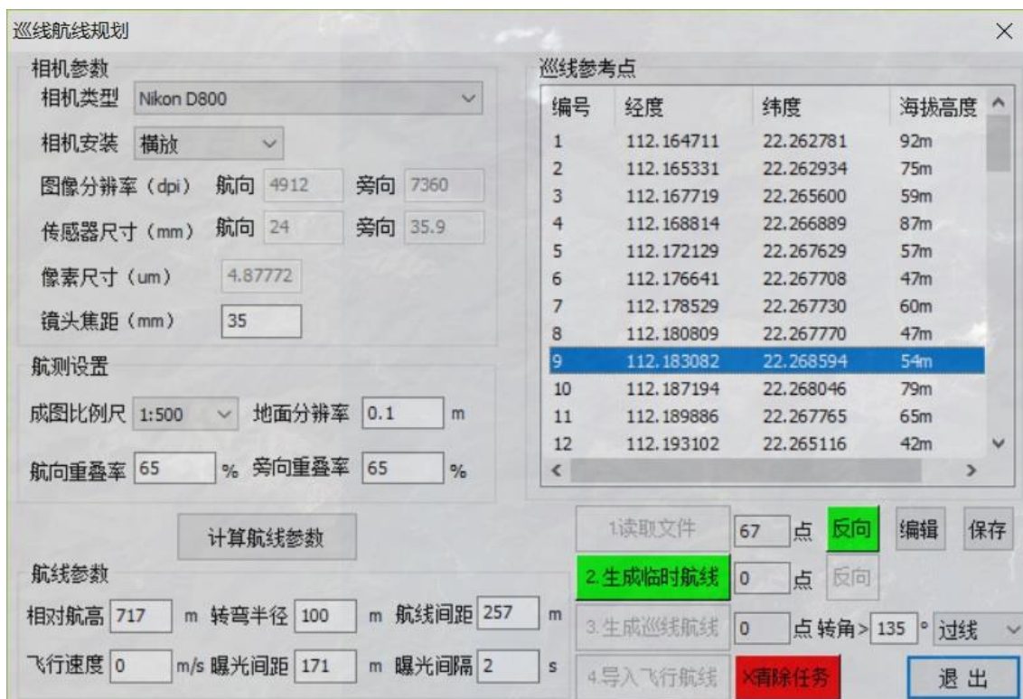
图 6.8.24 u3) 将经过高度查询后的文件再次导入巡线规划（带高程信息）
