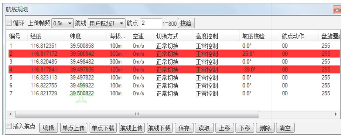
图 6.8.24 y) 航线坡度（纵倾角）自动检验、报警
